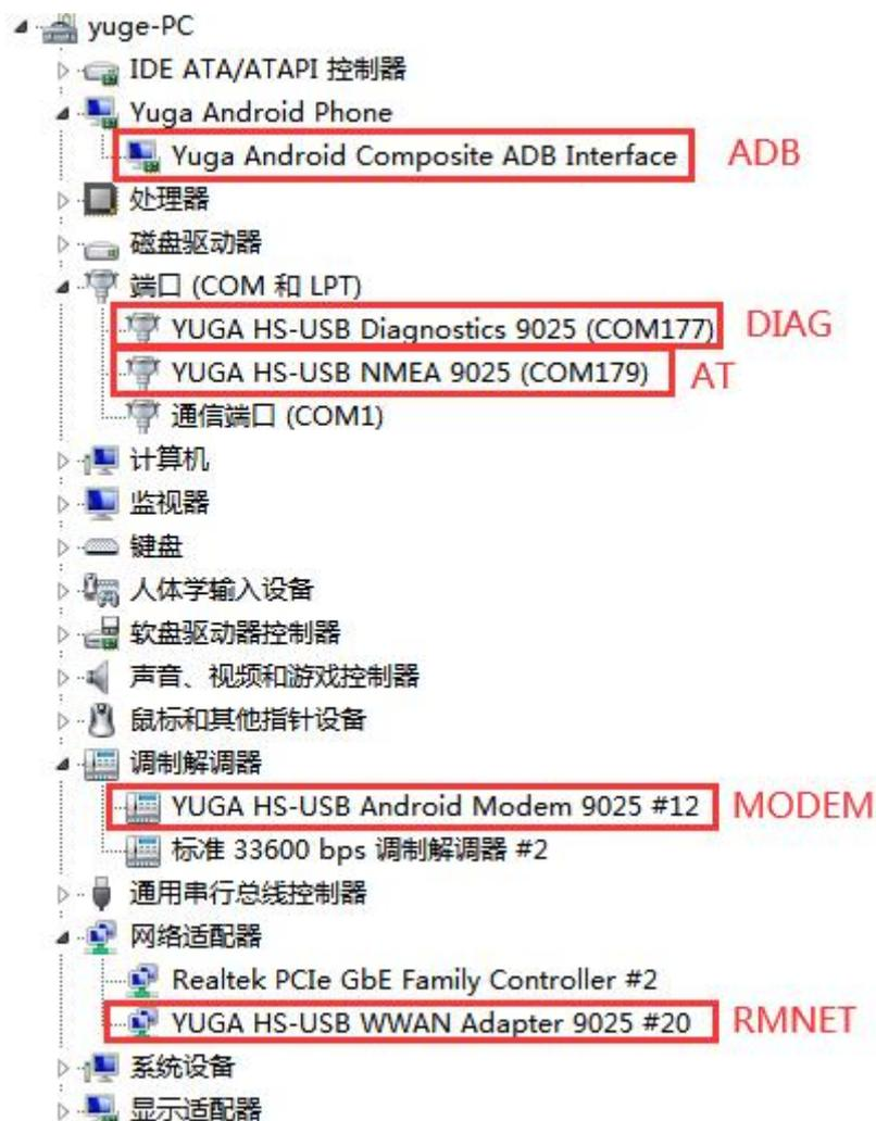
ADB 口、DIAG 口为调试及升级端口; AT 口为 AT 通信端口; MODEM 口为 modem 拨号端口, 未拨号时也可进行 AT 通信; RMNET 为虚拟网卡, 供 rmnet 拨号使用。
