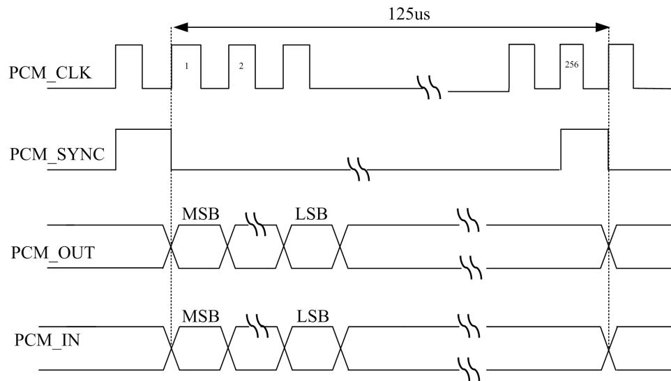
图 3-18 PCM 短帧模式时序图
