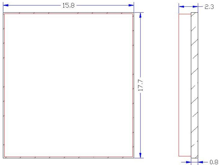
图 6-2 模块正视图与侧视图(单位: 毫米)
