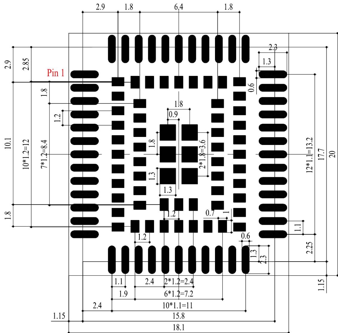
图 6-4 模块推荐封装(单位：毫米)
