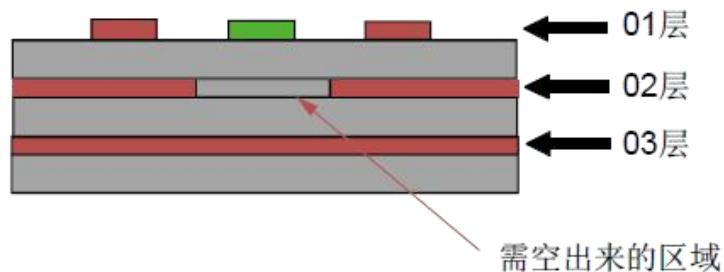
图 3-25 参考地为第三层 PCB 微带传输线结构
