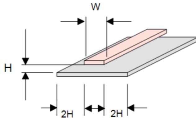
图 3-23 微带线的完整结构
