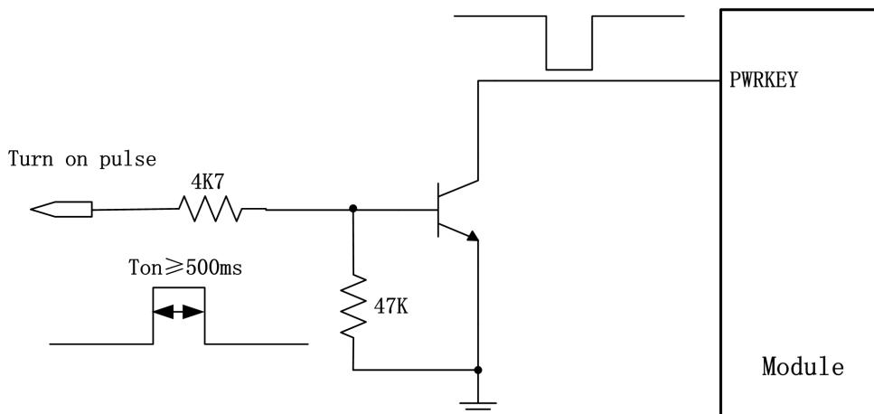
图 3-9 开集驱动开机参考电路
