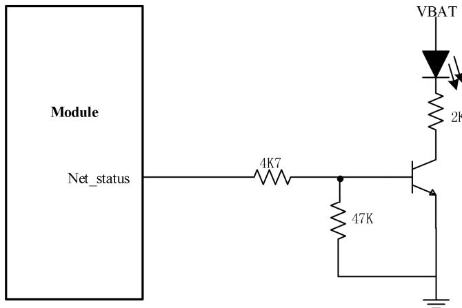
图 3-17 网络状态指示灯电路图
