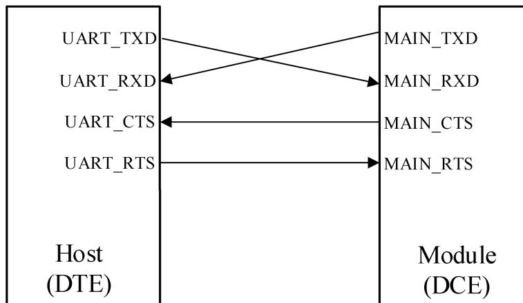
图 3-13 串口设计图
