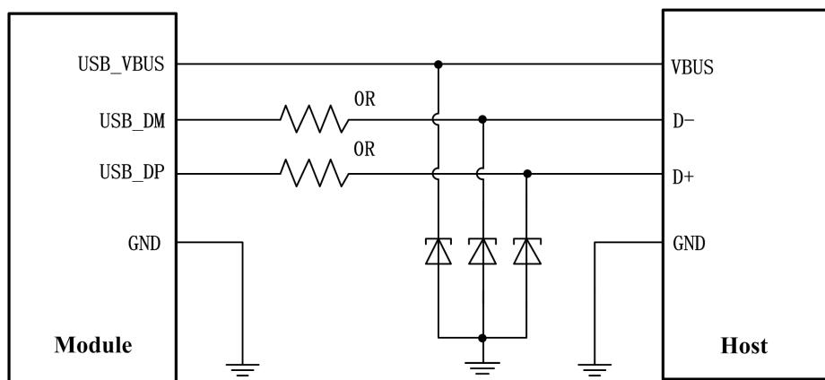
图 3-12 USB 连接设计电路图
