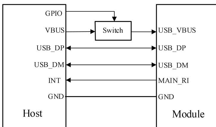
图 3-15D 不支持 USB 挂起功能硬件连接图上
