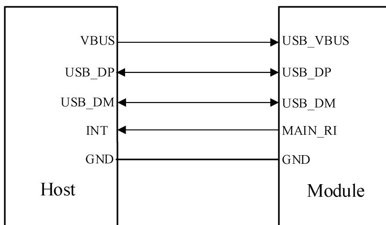
图 3-15C 支持 MAIN\_RI 唤醒功能硬件连接图
