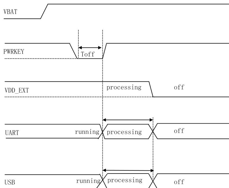
图 3-11 关机时序图
