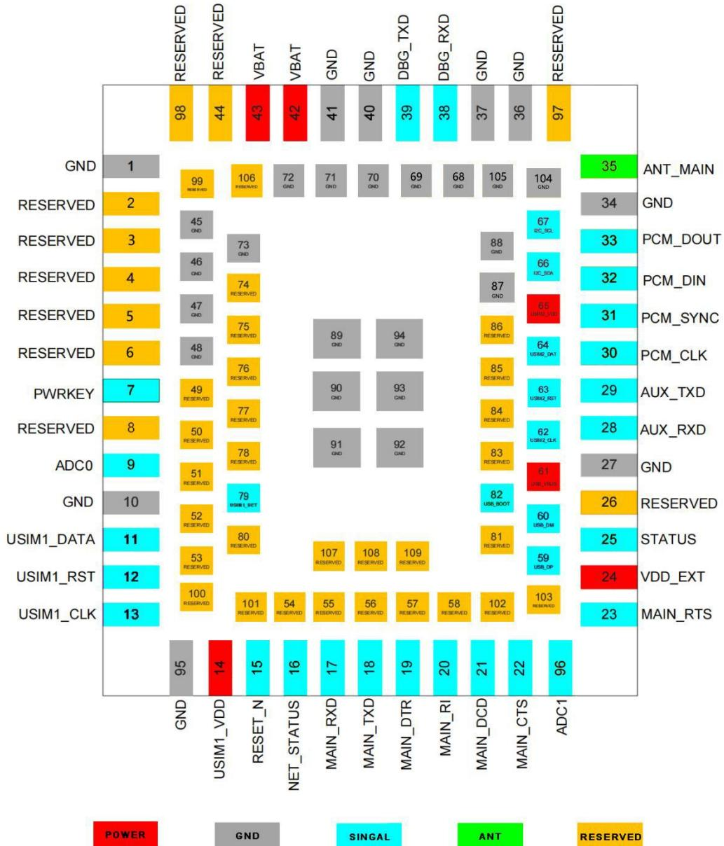
图 3-1 CLM920\_HE9 模块管脚分布图 (TOP 透視)
