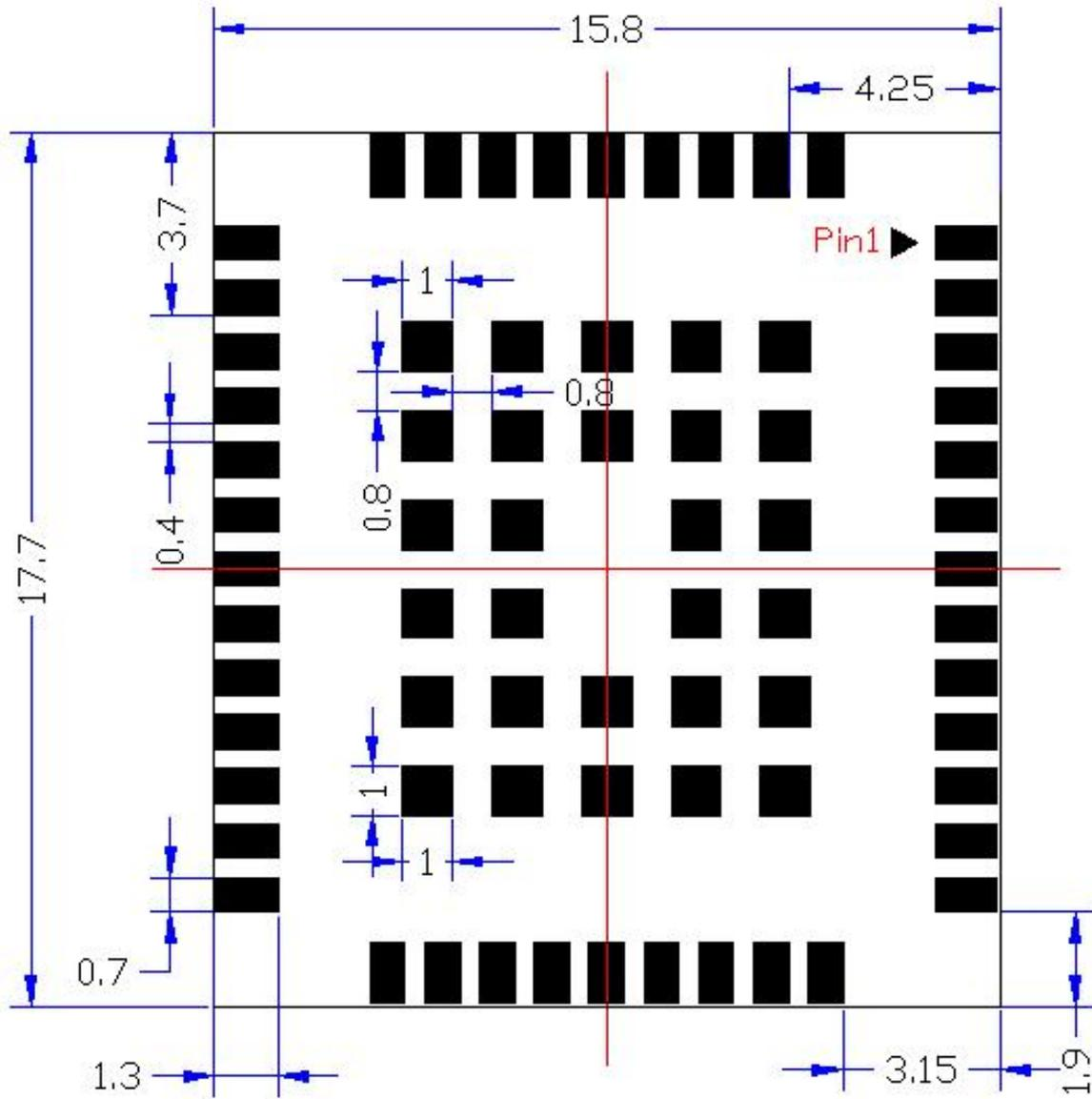
图 6-3 模块底视图（单位：毫米）
