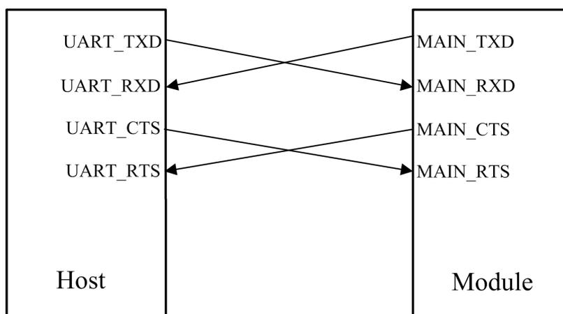
图 3-13 串口设计图
