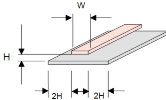
图 3-23 微带线的完整结构
