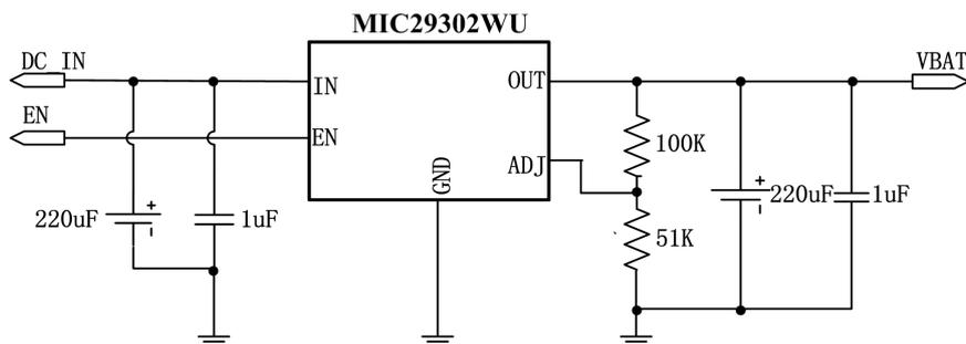
图 3-3 LDO 线性电源参考电路
