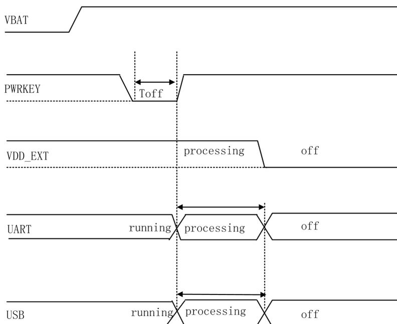
图 3-11 关机时序图
