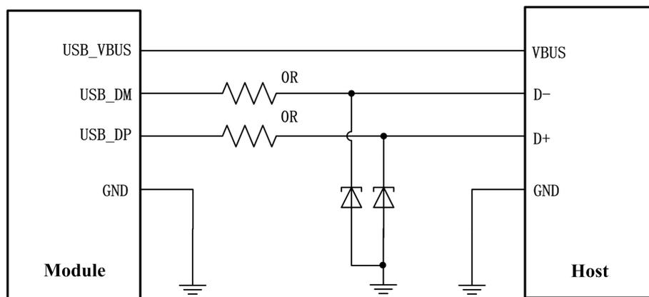
图 3-12 USB 连接设计电路图
