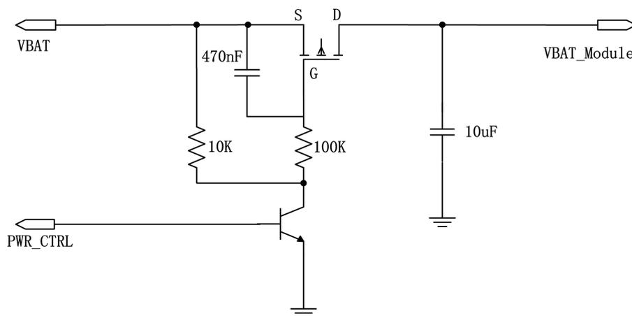
图 3-5 PMOS 管控制电源开关参考电路
