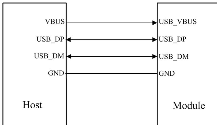
图 3-15B 支持 USB 远程唤醒功能硬件连接图
