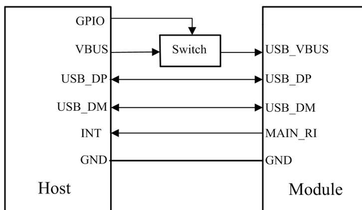
图 3-15D 不支持 USB 挂起功能硬件连接图
