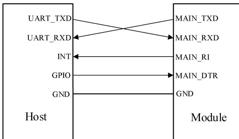
图 3-15A UART 接口休眠唤醒硬件连接图
