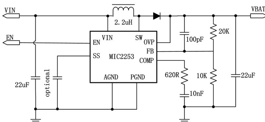
图 3-4 DC 开关电源参考电路
