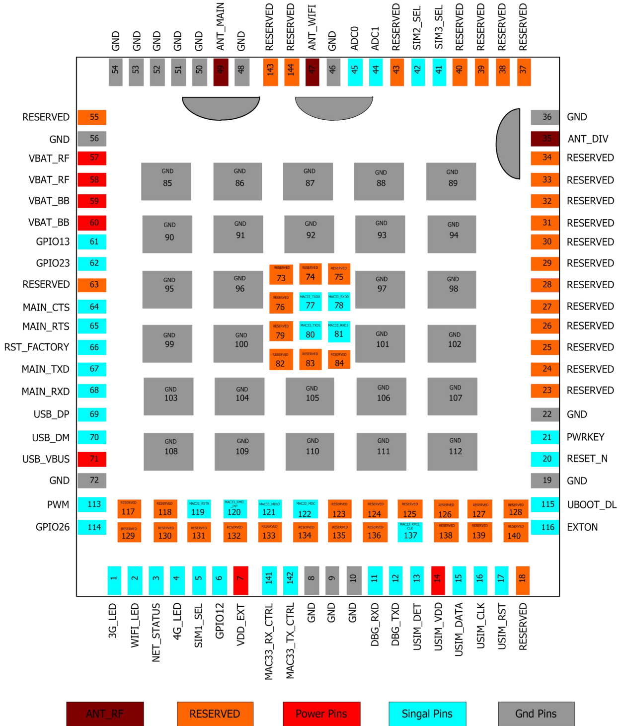
图 3-1 CLM920_JR3 模块管脚分布图（TOP 面透视）
