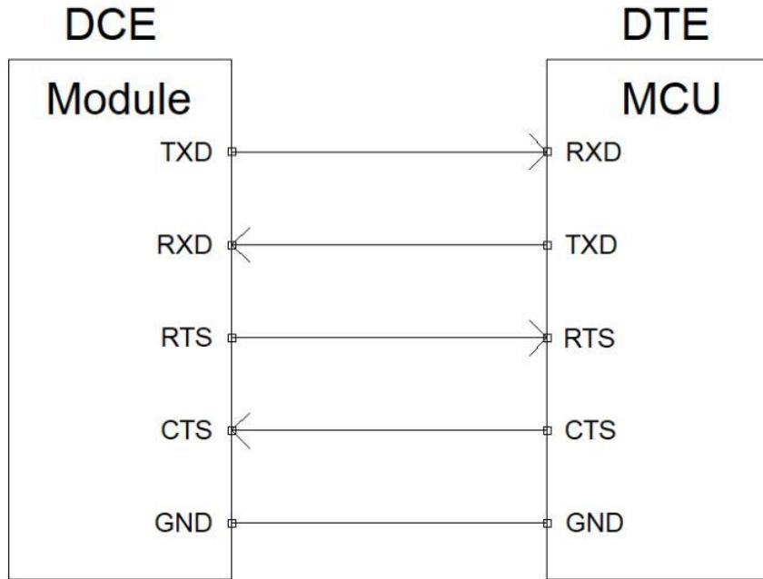
图 3-10 带流控的串口连接方式示意图
