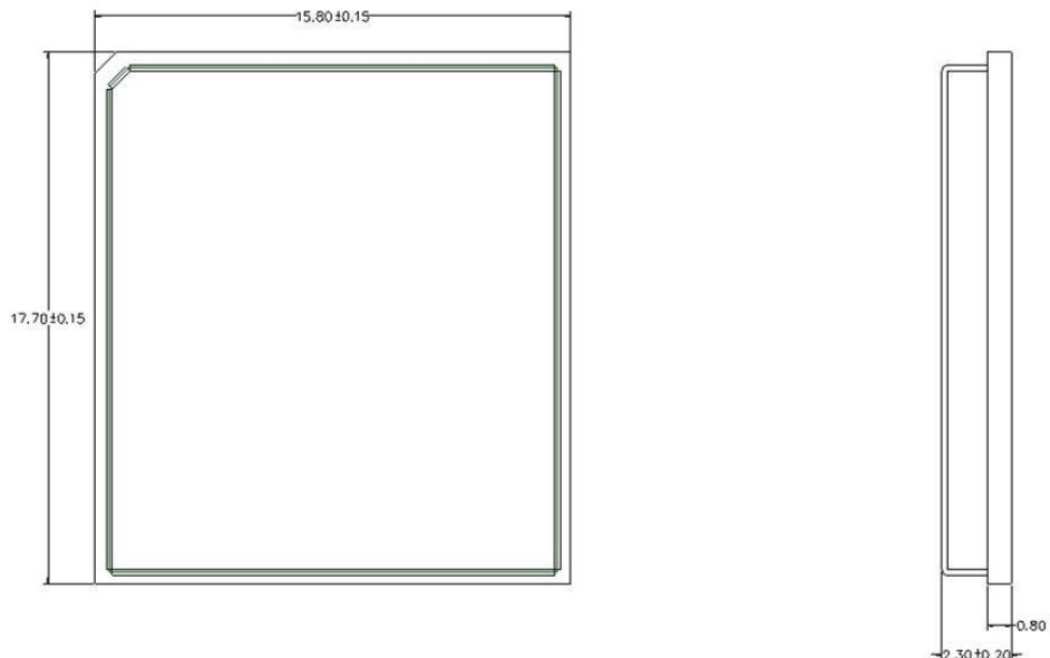
图 6-2 模块正视图与侧视图(单位：毫米)
