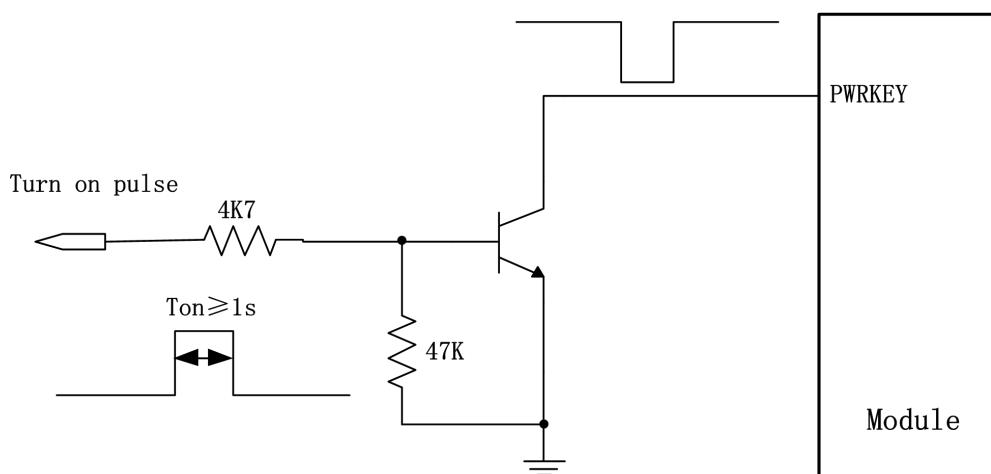
图 3-5 开集驱动开机参考电路
