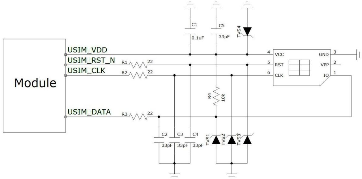
图 3-14 6pin USIM 设计参考电路图
