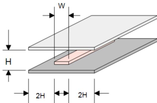
图 3-27 带状线的完整结构
