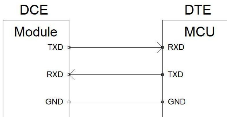
图 3-9 串口三线制连接方式示意图
