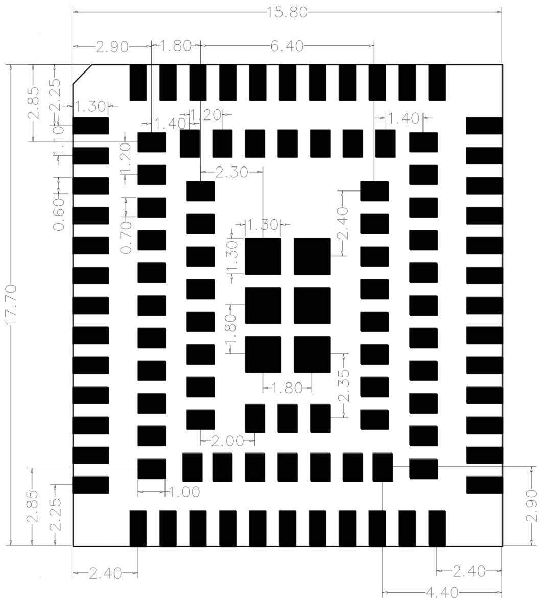
图 6-4 模块推荐封装(单位：毫米)
