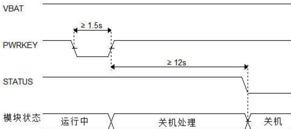
图 3-7 关机时序图
