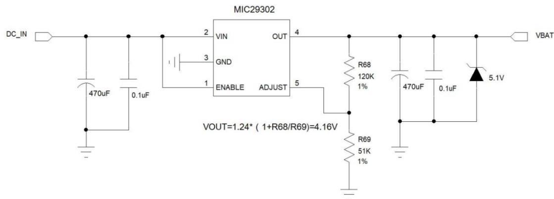
图 3-3 LDO 线性电源参考电路
