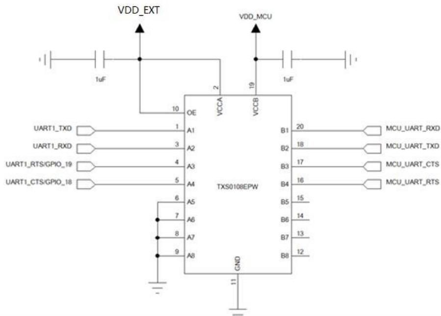
图 3-12 高波特率电平转换参考电路
