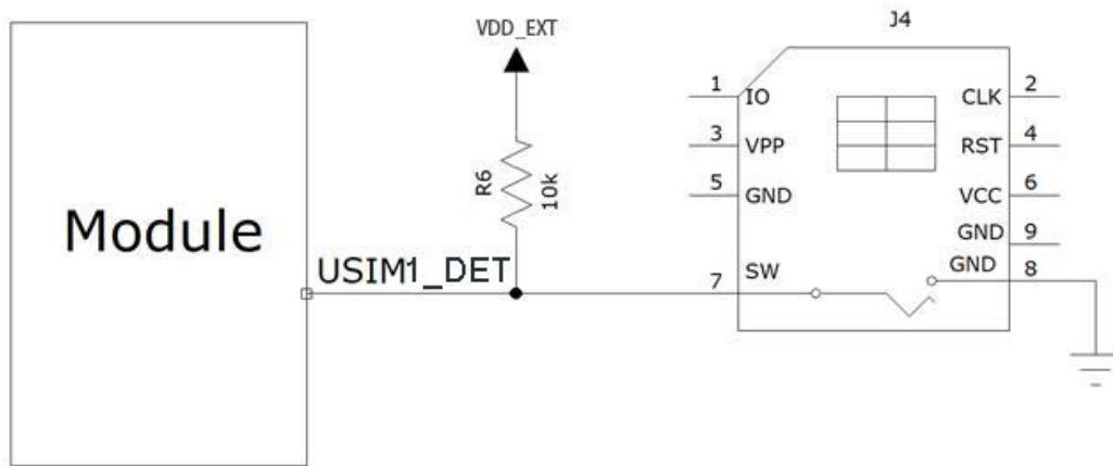
图 3-15 USIM1 热插拔检测卡座参考电路图
