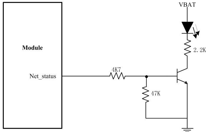
图 3-20 网络状态指示灯电路图
