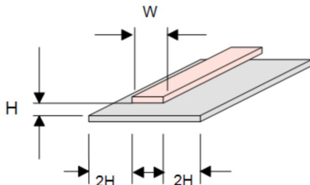
图 3-26 微带线的完整结构
