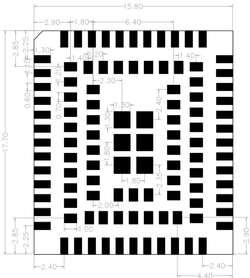
图 6-3 模块底视图 (单位: 毫米)
