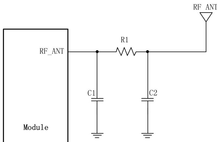
图 3-25 天线匹配电路
