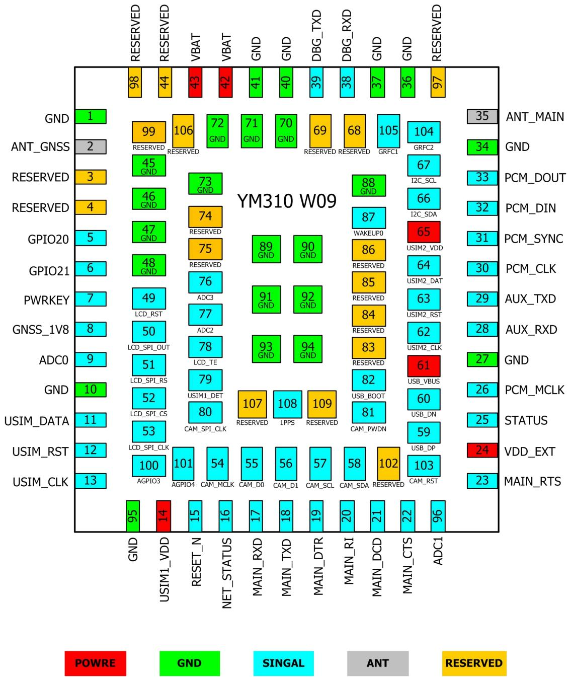
图 3-1 YM310 W09 模块管脚分布图 (TOP 透视)
