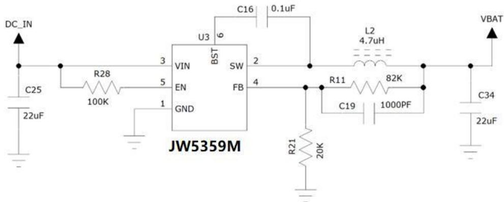
图 3-4 DC 开关电源参考电路
