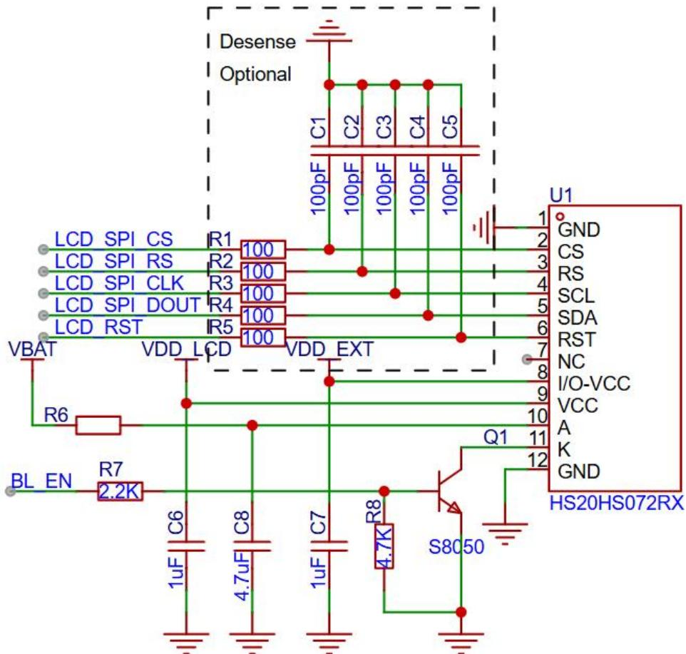
图 3-21 LCD 信号参考电路
