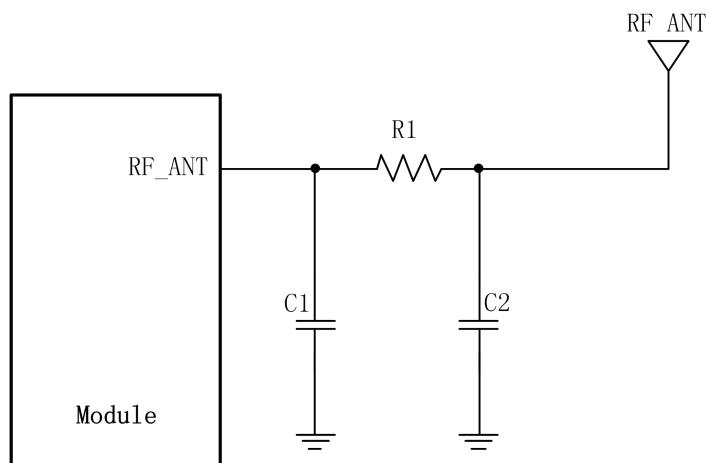
图 3-25 天线匹配电路
