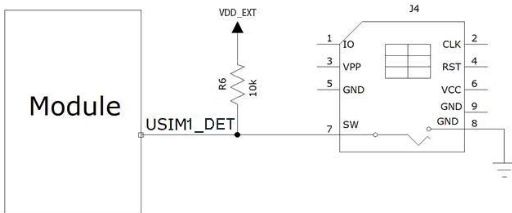
图 3-15 USIM1 热插拔检测卡座参考电路图
