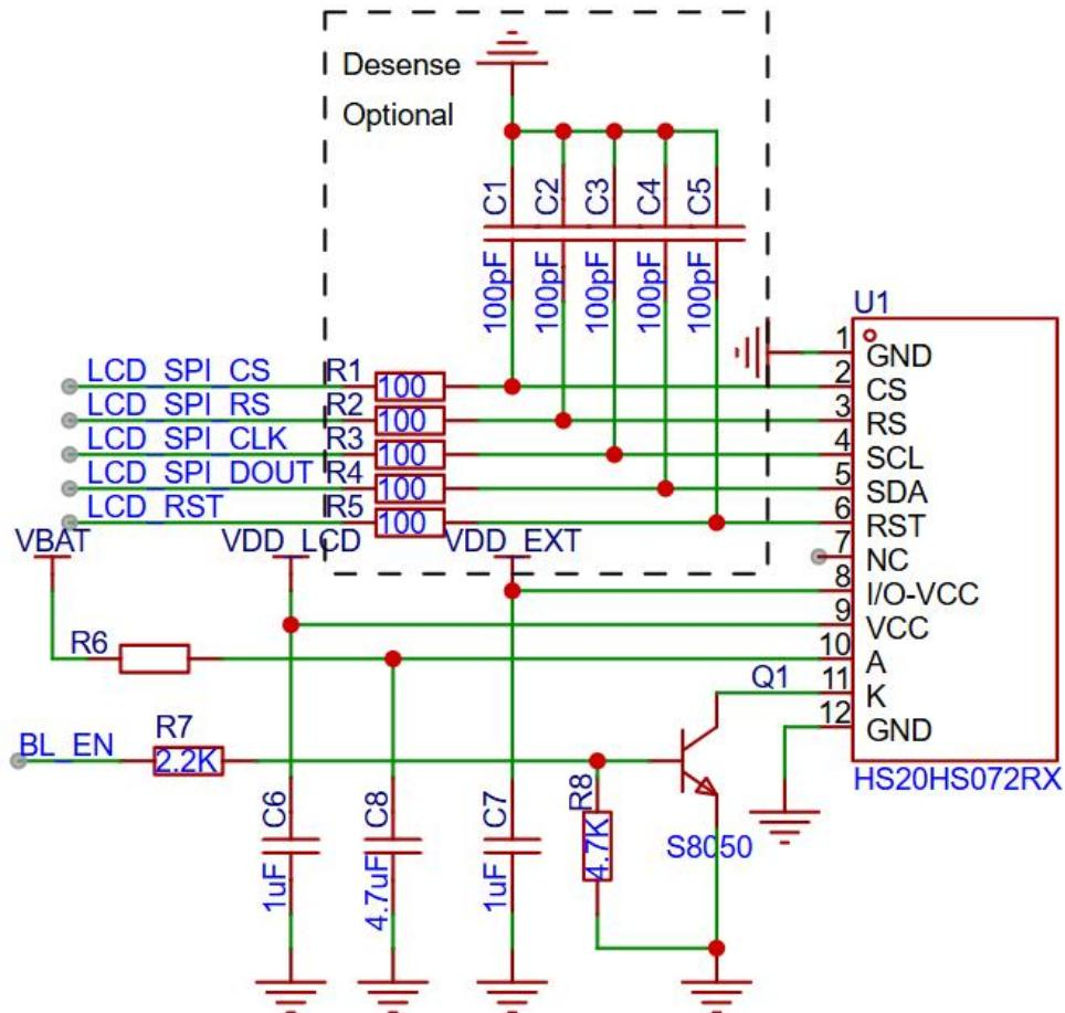
图 3-21 LCD 信号参考电路
