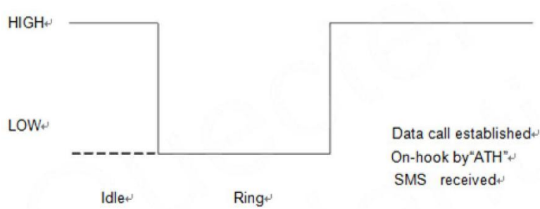
图 3-19 数据呼叫时模块用作被叫方 MAIN_RI 时序
