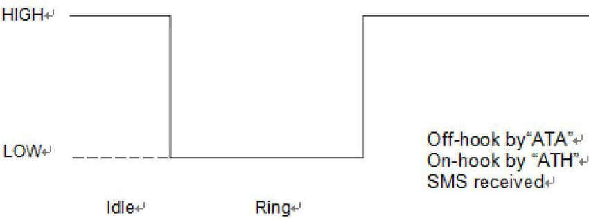
图 3-15 语音呼叫时模块用作被叫方 MAIN_RI 时序
