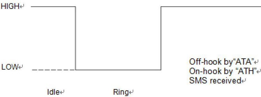
图 3-16 语音呼叫时模块用作被叫方 MAIN_RI 时序
