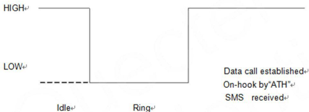
图 3-17 数据呼叫时模块用作被叫方 MAIN_RI 时序
