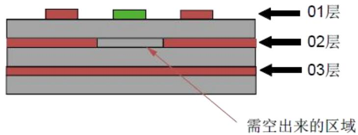
图 3-26 参考地为第三层 PCB 微带传输线结构
