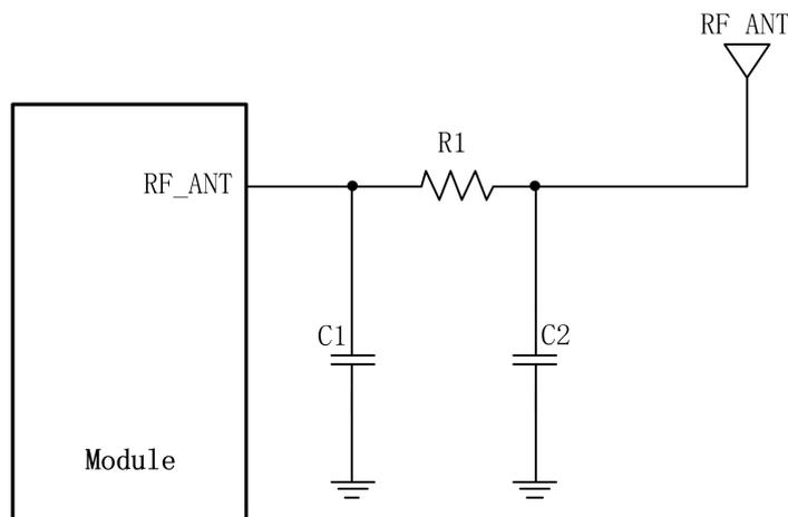
图 3-23 天线匹配电路
