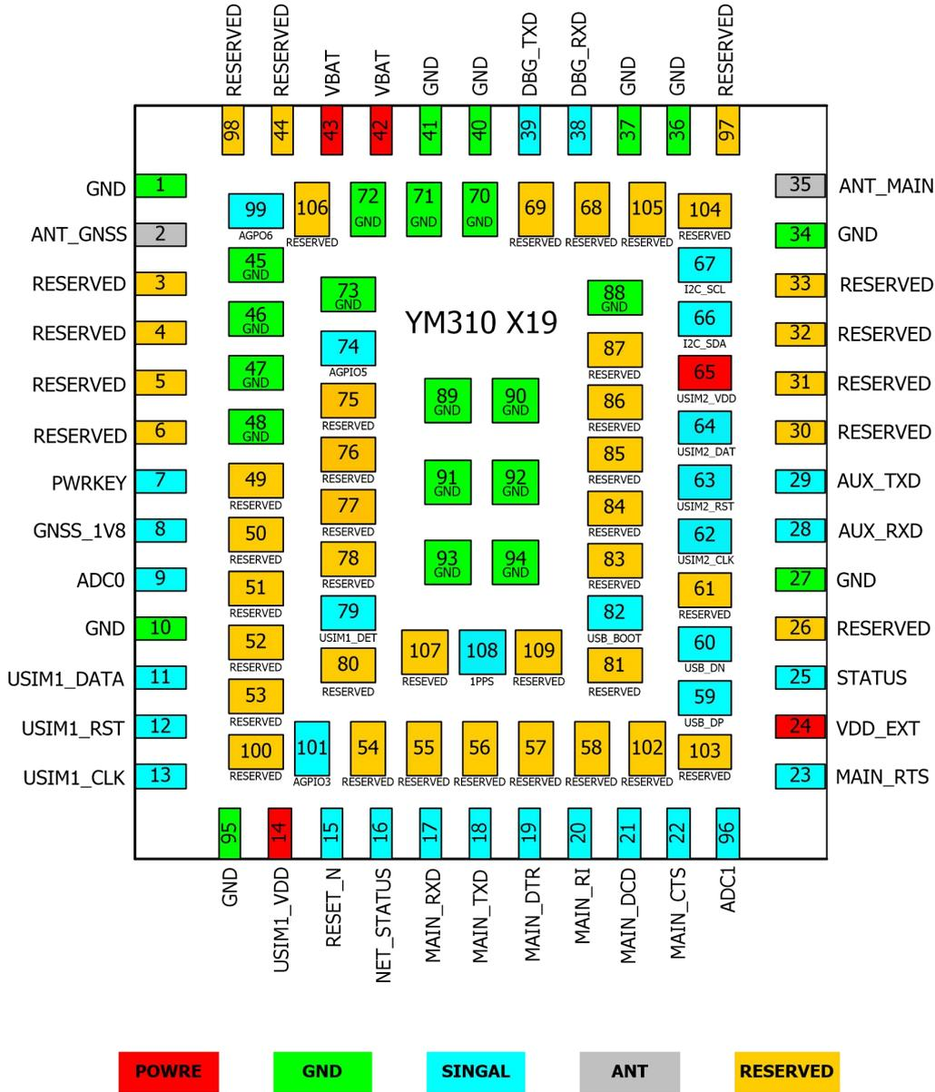
图 3-1 YM310 X19 模块管脚分布图 (TOP 透视)
