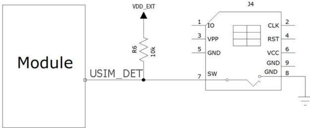
图 3-15 USIM 热插拔检测卡座参考电路图
