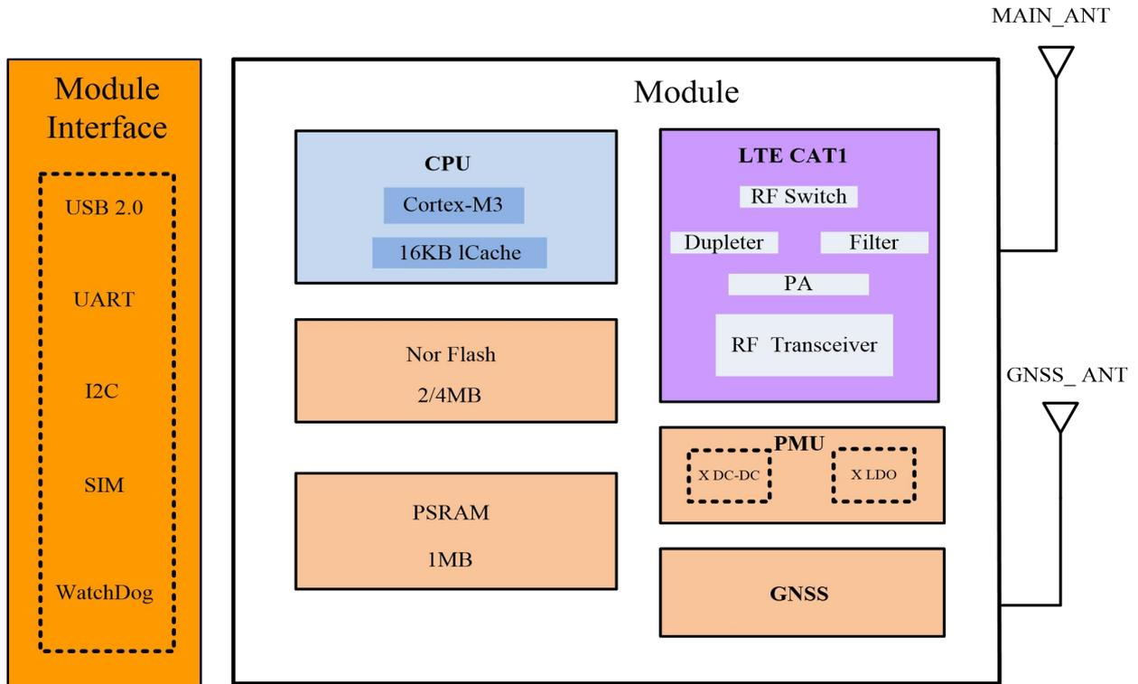
图 2-1 YM310 X19 模块功能框图
