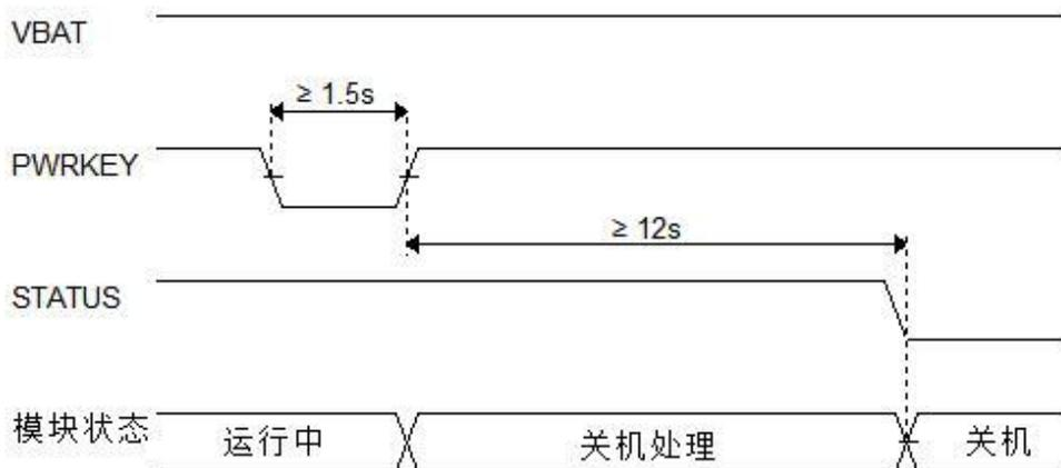
图 3-7 关机时序图
